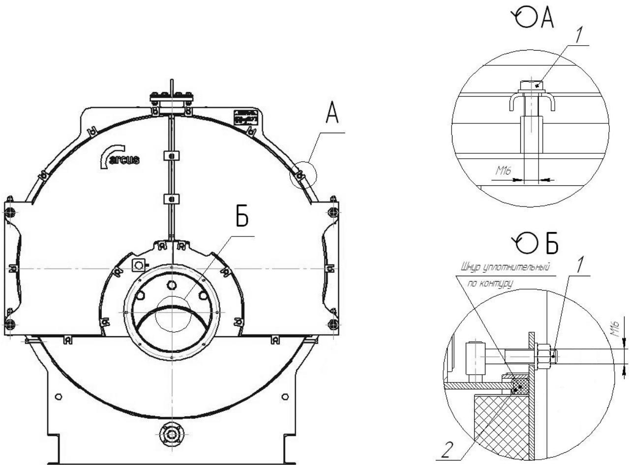
Рисунок 7. Передние поворотные крышки.
