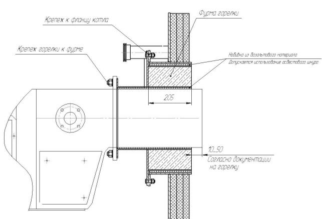
Рисунок 3. Крепление горелки
