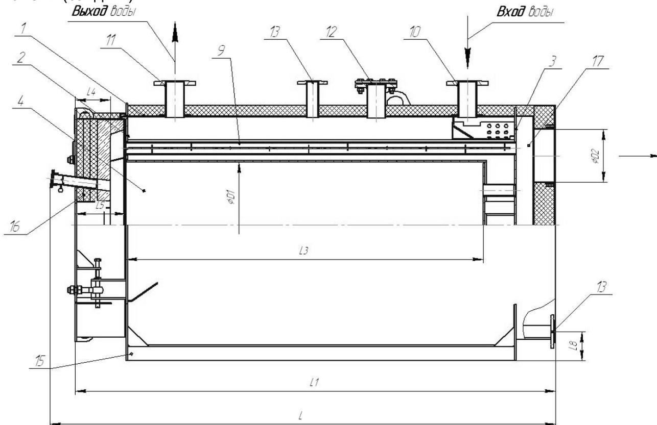
Рисунок 1. Схема котла
