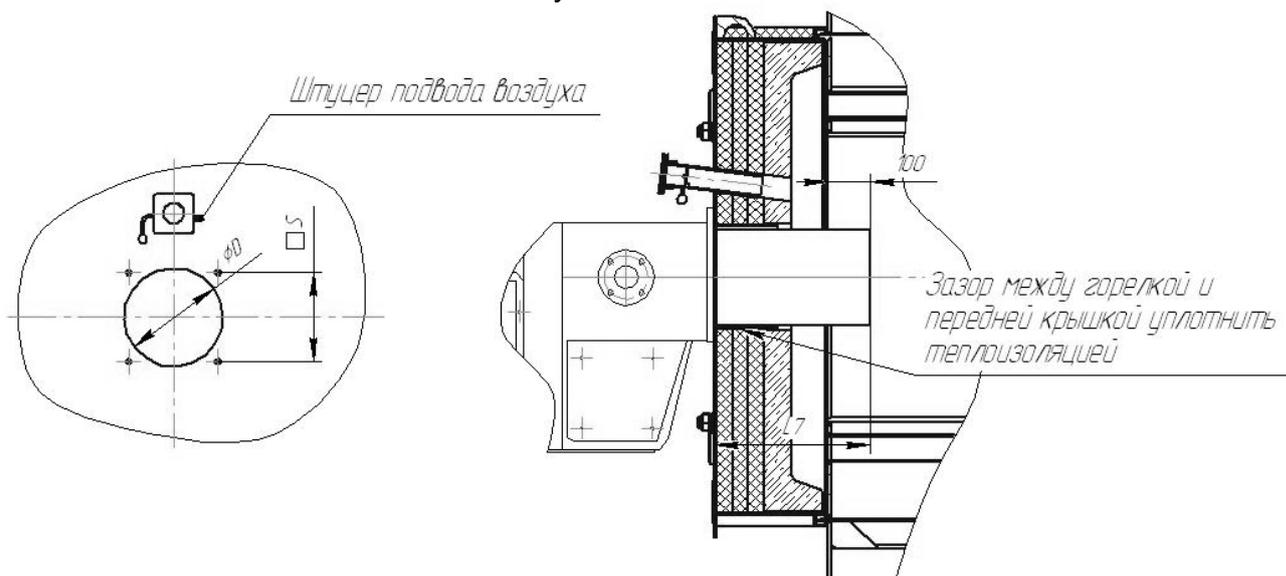
Рисунок 2. Отверстие под горелку
