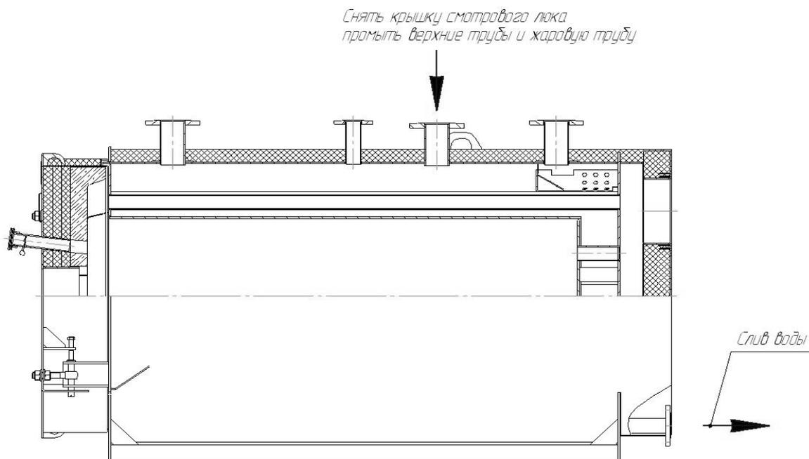
Рисунок 7. Вариант промывки котла.
